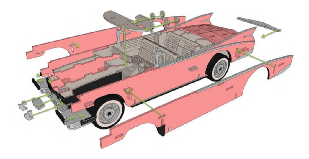
Rahmen und Anbauteile/ Body and attached parts
